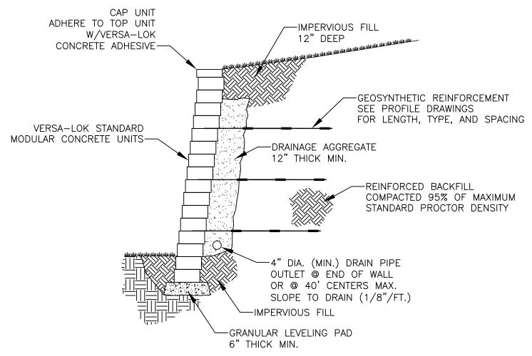
TYPICAL SECTION-REINFORCED RETAINING WALL
