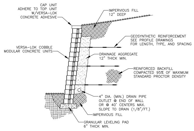
TYPICAL SECTION-REINFORCED RETAINING WALL
